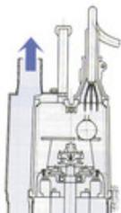
Перекачиваемая жидкость охлаждает двигатель и выпускается как показано. Двигатель охлаждается даже при перекачке малого количества жидкости. Выпуск сверху обеспечивает доступ в места с ограниченным пространством.
